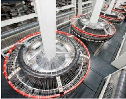
Рис. 3. Изготовление тканых рукавов из полипропиленового волокна
